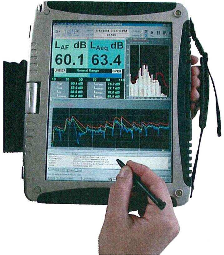
Die Signal-Analyse wird mit der auf dem im Toughbook installierten siNoise-Software durchgeführt. Von dieser Software ist die Version 2.2.7 zugelassen.
