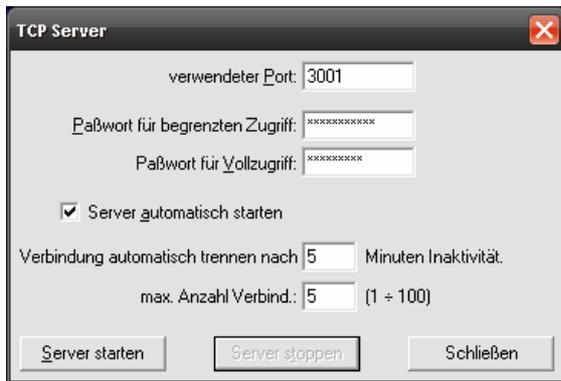
Diese Schnittstelle ermöglicht externen Programmen SAMURAI zu konfigurieren, zu bedienen und Messdaten von SAMURAI über TCP/IP zu empfangen. SAMURAI wird damit netzwerkfähig.
