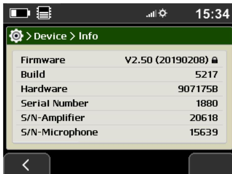
Abbildung 3.13: Anzeige der eichfähigen Firmwareversion mit Schloss-Symbol
